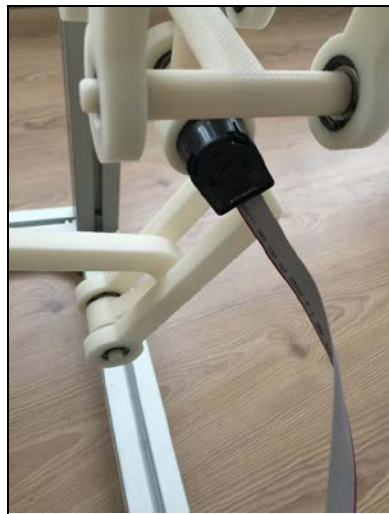
Fig. 8. Maxon HEDL-5540 encoder
